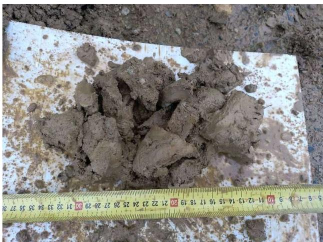
Sol : remblais (blocs de roche + argile limoneuse)
