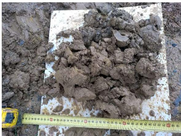
Sol : remblai (blocs de roches – argile limoneuse)
